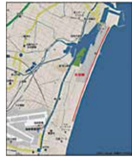
図2 仙台空港（左下）と東須賀海岸 赤線区間が防潮堤の築かれていなかった延長4kmの砂浜海岸
